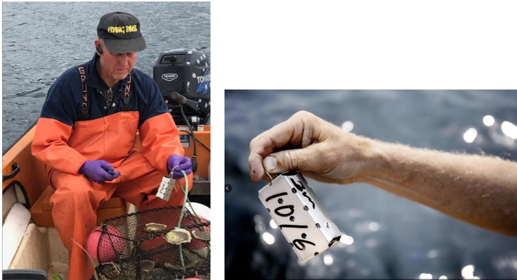
Fig. 8. SPMD-provtagare innehållande membran. Dessa sattes fast på linan 25cm ovanför burarna för att mäta PAH-halterna i vattnet.
